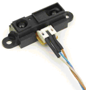
Figura 4. Módulo SIDST-GP2 medidor de distancia.
