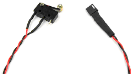
Figura 3. Módulo SISW-SPST, un simple pulsador.
